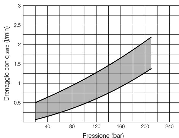
Valori indicativi rilevati su banco prova Berarma, riferiti a 1500giri/min con olio idraulico HM secondo ISO 6743-4, ISO VG 46 secondo ISO 3448, temperatura 40°C. Distanza fonometro 1 metro e accoppiamento con giunto elastico.
