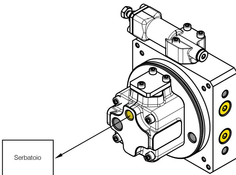
Configurazione con drenaggio su scambiatore di calore esterno
